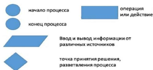
Рисунок 1 – Пример графического оформления при визуализации процессов
